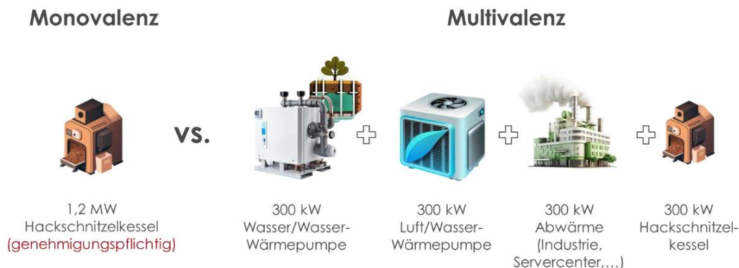
Abbildung 02-5: Substitution eines genehmigungspflichtigen Wärmeerzeugers
