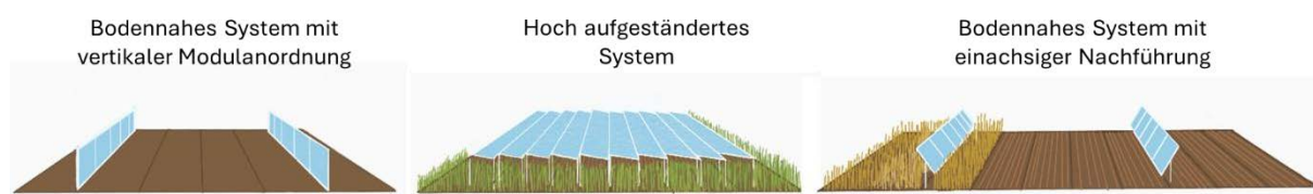
Abbildung 04-2: Synergien zwischen Landwirtschaft und Stromproduktion mittels Agri-PV Anlagen 58
